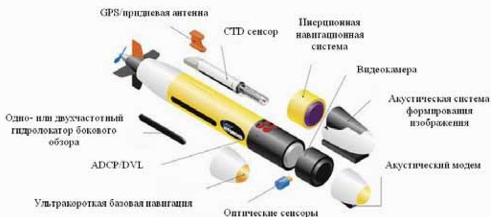
**Рис. 5** Модульный принцип построения водных РТС на примере «Gavia» и «Remus»
